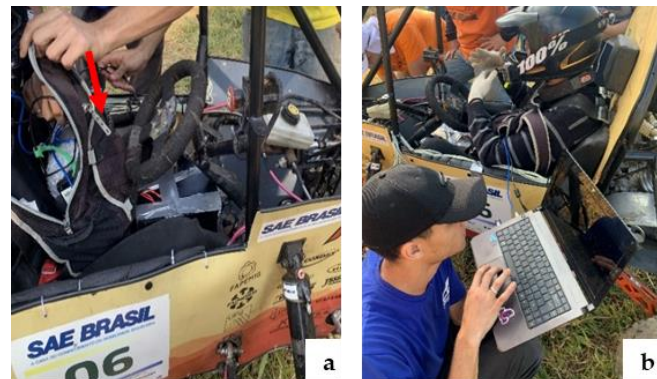
Figura 6. Arranjo do módulo e laptop em mochila (a), configurando gravação dos dados no software LYNX SignalVista (b). Fonte: Autor (2024).
